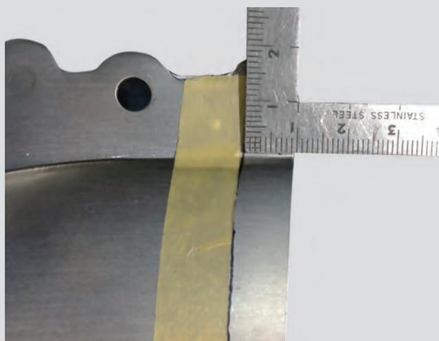
右用マフラーフィニッシャは車体とのクリアランスを確認しながら、1cm～1.5cmカットして取付けをして下さい。
