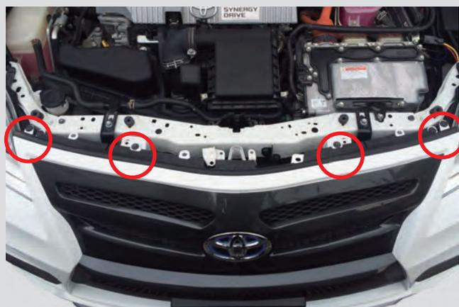
【純正クリップ、ボルト】で取付けて下さい。(4ヶ所)
