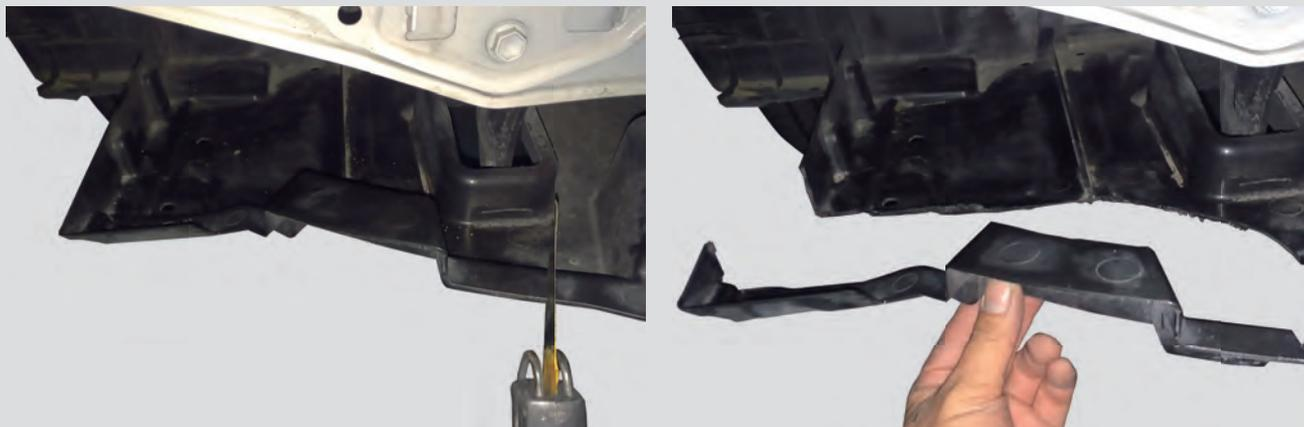
左用マフラーフィニッシャは純正アンダーカバー干渉部をカットして取付けをして下さい。
