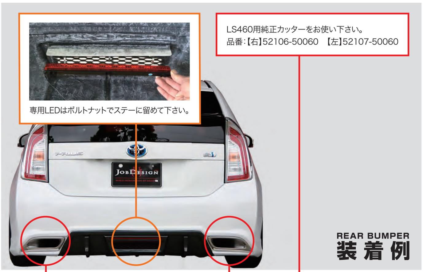
専用LEDはボルトナットでステーに留めて下さい。
