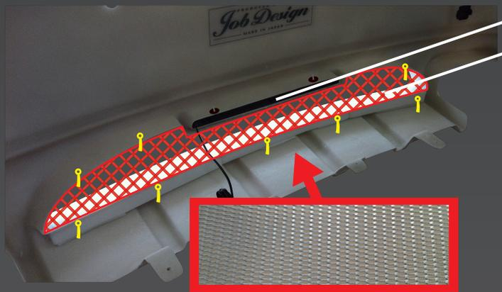
専用LEDはボルトナットでステーに留めて下さい。
